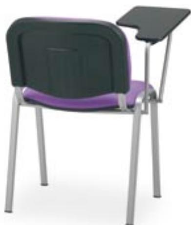
**ARIES 2:** Silla de colectividad con asiento y respaldo acolchado en espuma moldeada de 25kg/m<sup>3</sup>, tapizada. Con pata-brazo formando parte de la estructura, en tubo oval de 30x15x1,5 mm, con acabado pintado negro o gris plata, y opcionalmente cromado. Apilable.
