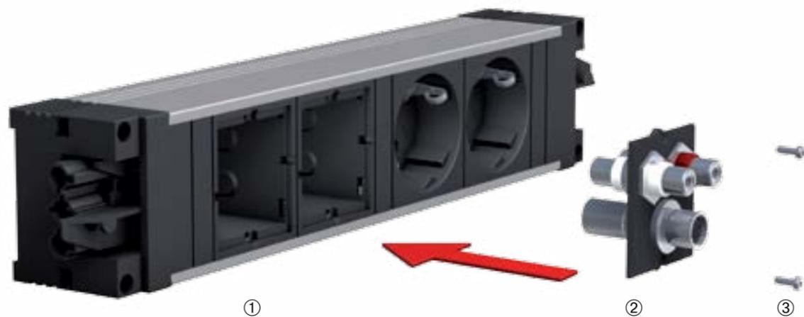
La estructura vacía ① de los sistemas de Bachmann Facility acomoda los módulos personalizados ②, que se fijan con dos tornillos Torx ③. Los módulos personalizados se cambian aflojando los tornillos.
